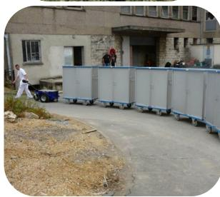
Le PTP 11 est un pousseur directionnel tracteur à trois roues, accompagnant à motorisation électrique (batterie).
